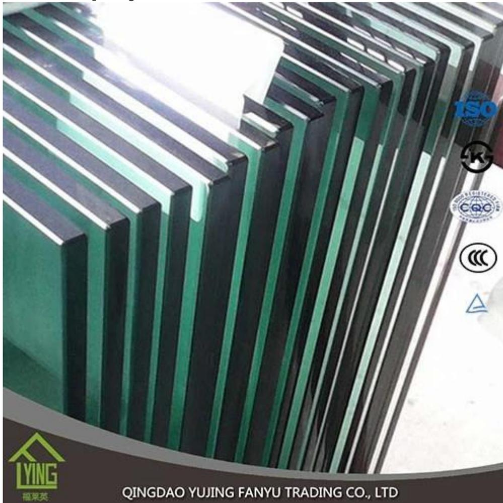
Tempered Glass ist eine Art von Sicherheitsglas, die durch kontrollierte thermische oder chemische Behandlungen verarbeitet werden, um seine Stärke gegenüber normalem Glas zu erhöhen. Abschrecken legt die äußeren Flächen in der Komprimierung und die inneren Flächen in Spannung fest. Solche Spannungen bewirken, dass das Glas, wenn gebrochen, in kleine Stücke zerlegt wird, anstatt Splitter in verzweigte Scherben zu schneiden. Die granulare Chunks sind weniger wahrscheinlich zu Verletzungen führen.
