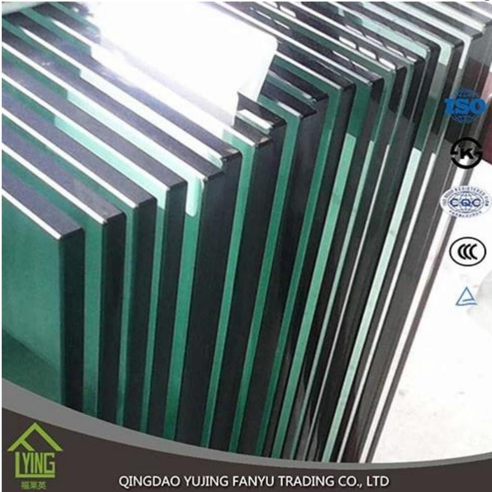
El vidrio templado es un tipo de vidrio de seguridad procesado por los tratamientos termales o químicos controlados para aumentar su fuerza comparada con el vidrio normal. El apagado fija las superficies externas en la compresión y las superficies internas en tensión. Tales tensiones causan el vidrio, cuando está quebrado, ser desmenuzado en pedazos pequeños más bien que astilla granular en los fragmentos dentados. Los trozos granulares son menos propensos a causar lesiones.
