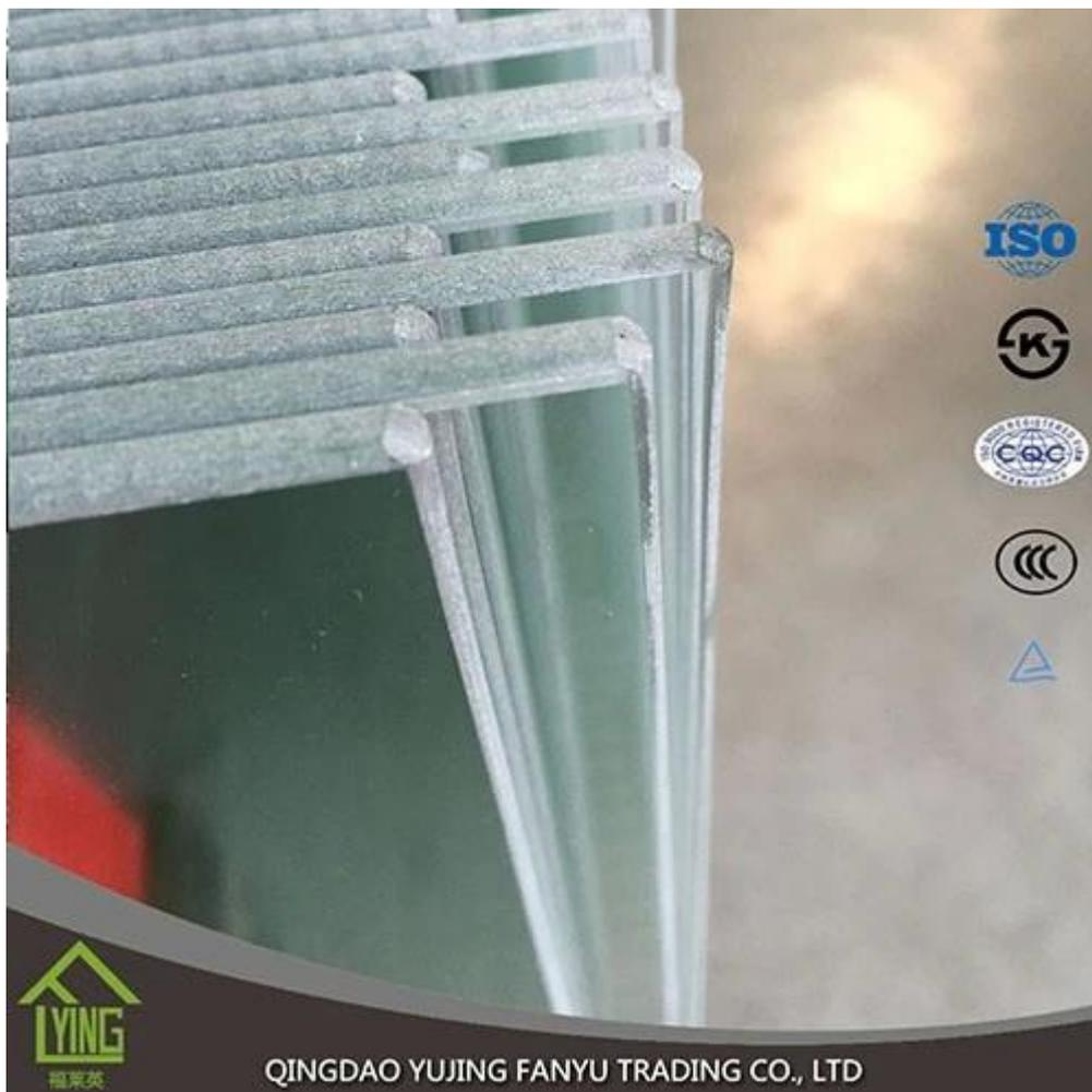
Закаленное стекло (упрочненное стекло) в 4-5 раз сильнее, чем аннеал стакан равной толщины. Южинг с умеренным стеклом-это вид безопасного стекла, который очень популярен в здании, декоративном и автомобильном поле. Вся работа, проделанная на стекле (скос, резка, изгиб и т. д.), должна быть сделана до того, как будет сдержан.
